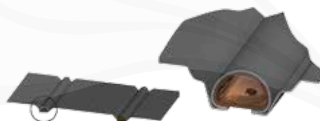
Spojení absorberu se sběrnou trubicou.
