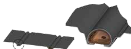
Spojení absorberu se sběrnou trubicí.
