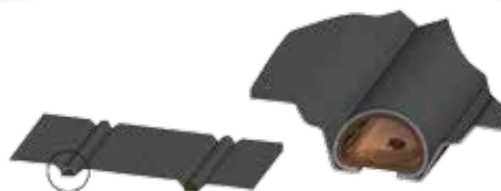
Spojení absorberu se sběrnou trubicí.
