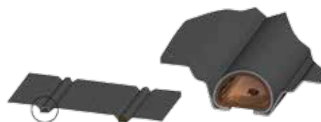
Spojení absorberu se sběrnou trubkou.
