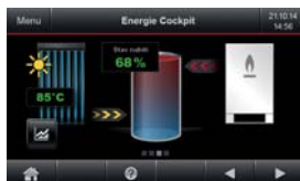
Regulace Vitotronic s barevným dotykovým displejem a funkcí Energie Cockpit.
